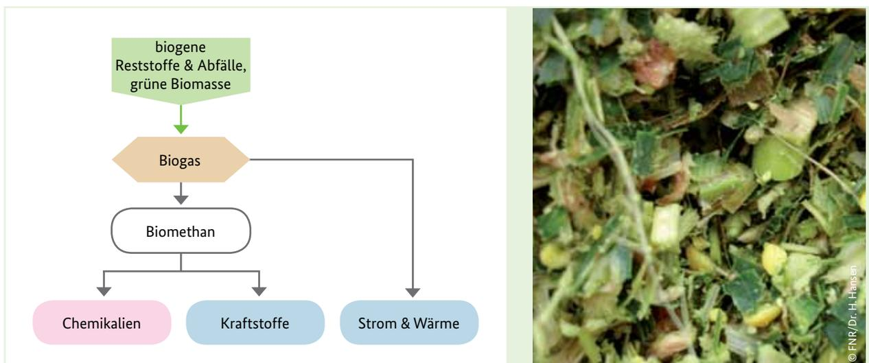
Abbildung 24: Prinzipschema einer Biogas-Bioraffinerie<sup>36</sup>
