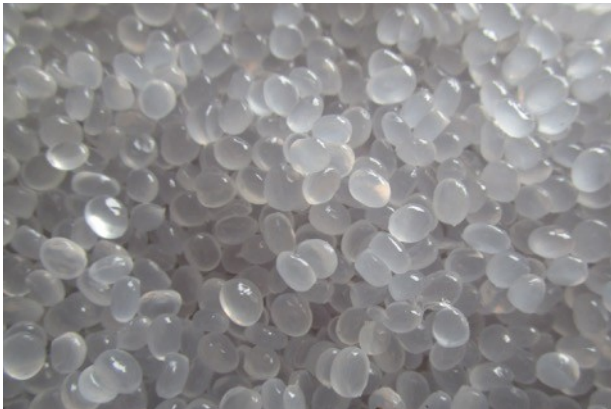
Das biobasierte Granulat von TECNARO kann zu unterschiedlichen Werkstoffen weiterverarbeitet werden. © TECNARO GmbH
