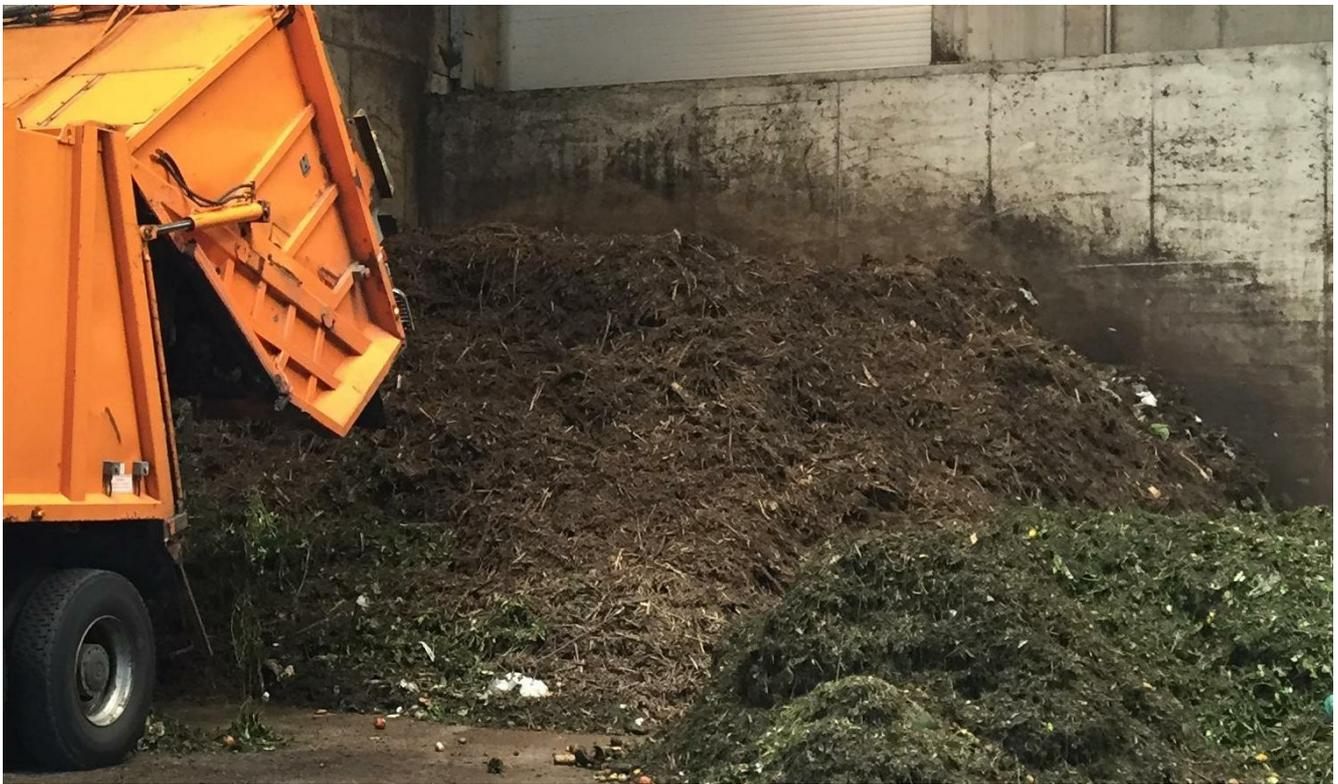
Bioabfallanlieferung in Backgang: Der Bioabfall stammt aus den Haushalten des Rems-Murr-Kreises. Er besteht hauptsächlich aus Küchen- und Gartenabfällen. Damit die Masse nach der Vergärung in der Biogasanlage die richtige Konsistenz zum Abpressen hat, werden rund fünf Prozent Grüngut mitverarbeitet.
