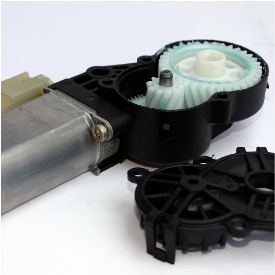
Schmierung eines Verstellgetriebes (Sitzverstellung)
