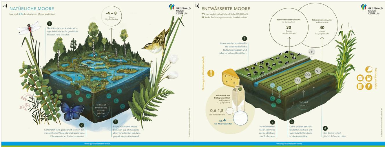
Schema eines a) natürlichen, intakten Moors und eines b) entwässerten Moors.
