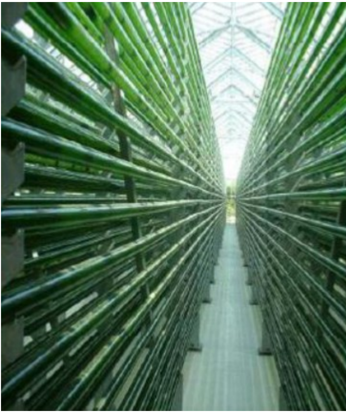
Photobioreaktoren der Anlage in Klötze, Sachsen-Anhalt. © Bioprodukte Prof. Steinberg GmbH
