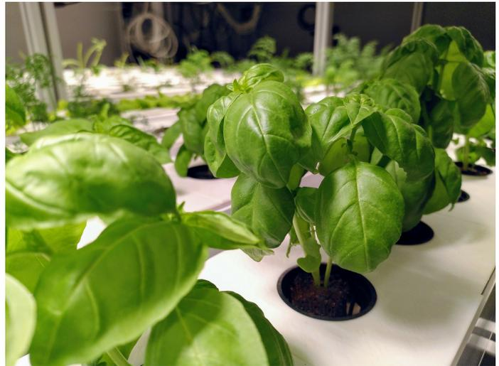
Pilotanlage von ROKO Farming: Die nachhaltige Methode verbindet die Vorteile des Vertical Farming mit denen der Aeroponik und Prozessautomatisierung, um im modularen und kontinuierlichen System nacheinander pflanzliche Erzeugnisse zu ernten.
