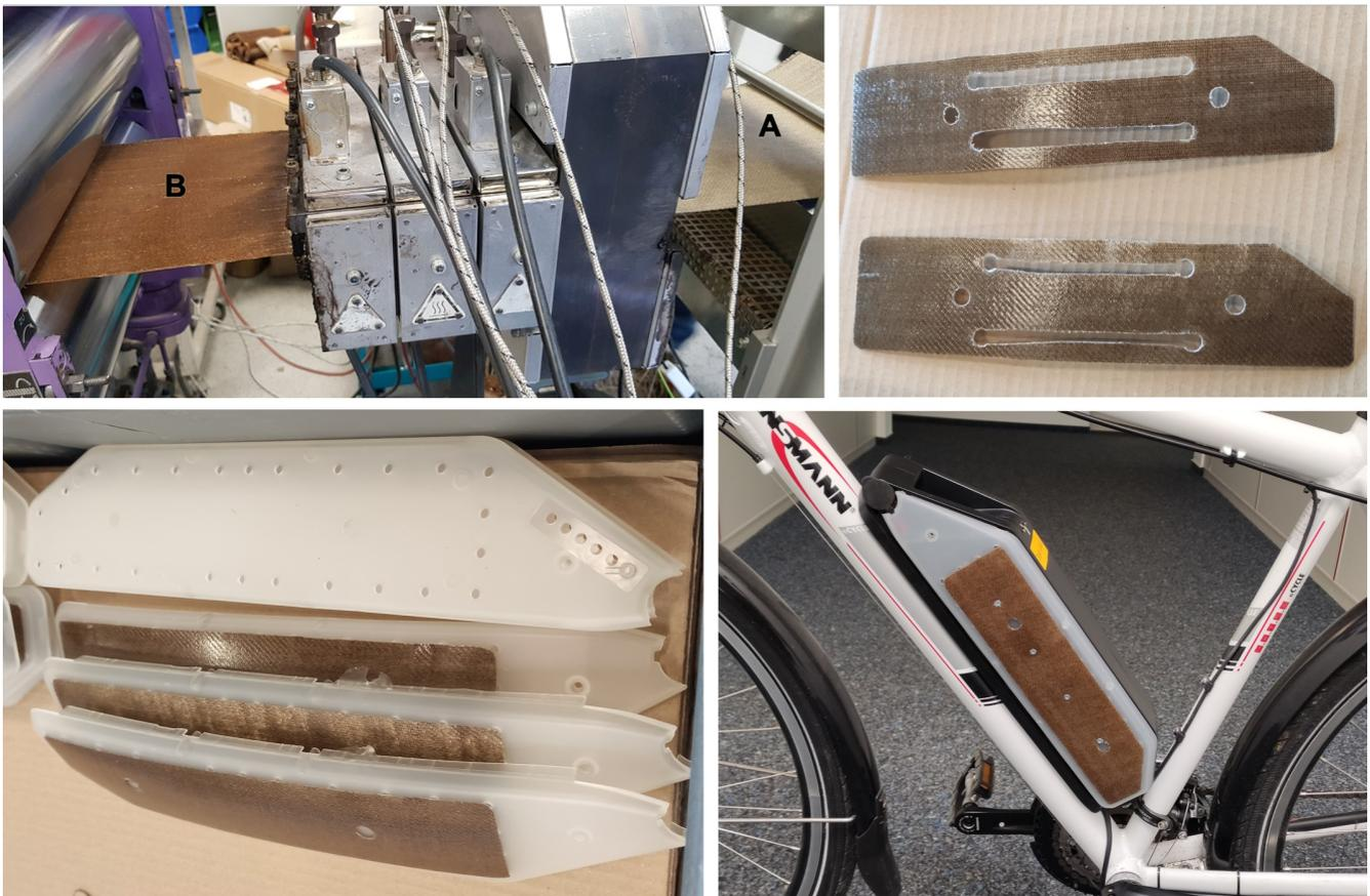
Aus Flachsgewebe (A) und Polypropylen werden dünne Organobleche (B) gefertigt, die zur Verstärkung der Gehäuseblenden eines E-Bike-Akku dienen.
