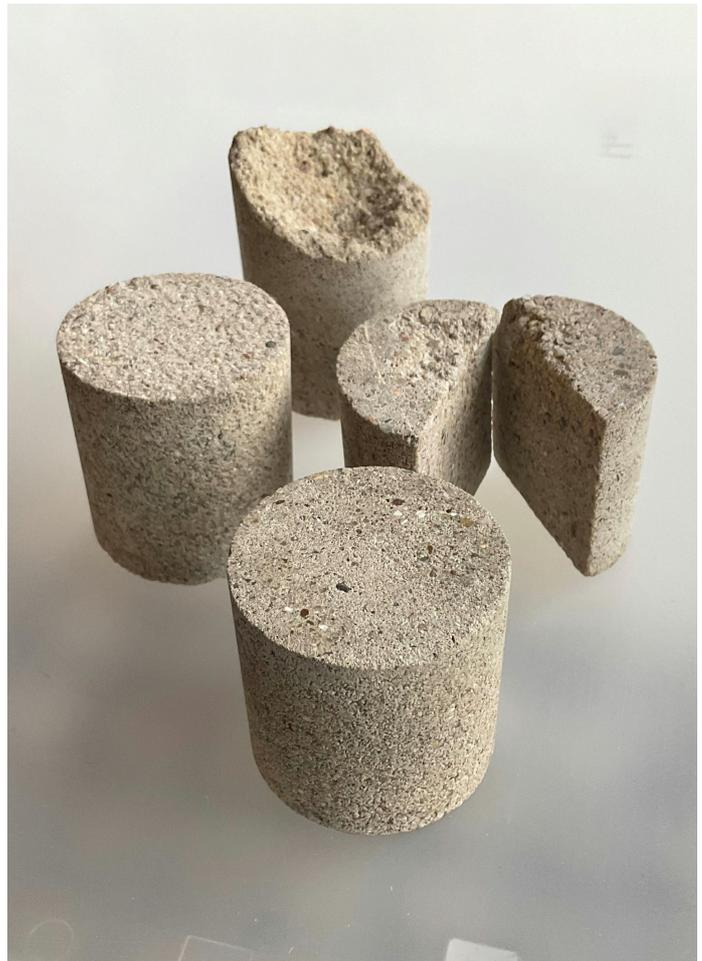
Die durch mikrobiologisch induzierte Calcitausfällung hergestellten Probekörper aus Biobeton besitzen bereits eine hohe Druckfestigkeit.
