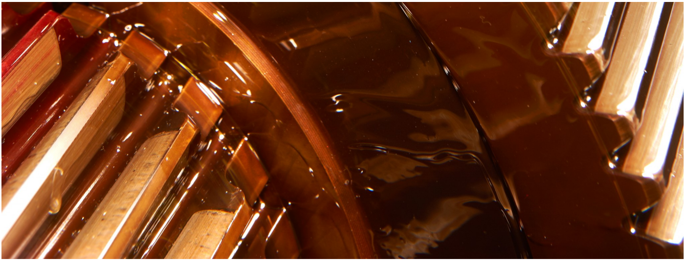
Befüllung eines Windkraftgetriebes mit Bioschmierstoff © FNR/Hardy Müller
